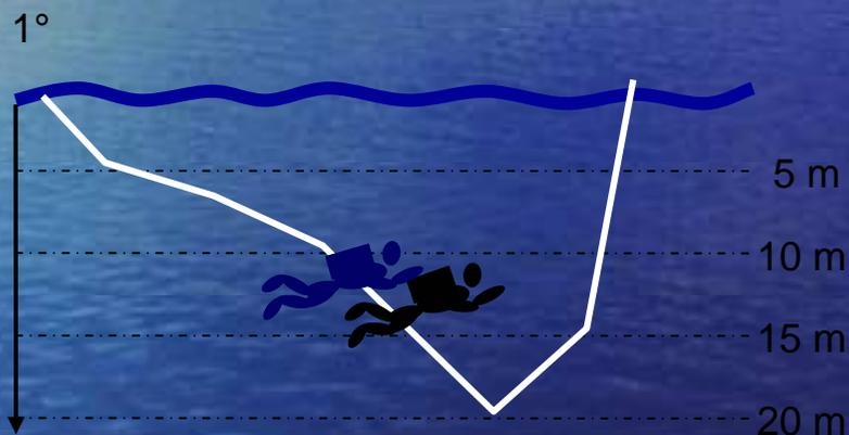
Pour aller dans le sens de la sécurité, il est conseillé d'effectuer le début de sa plongée à la profondeur la plus importante prévue
